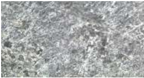
Gambar 2. 1 Struktur mikro sebelum heat treatment pembesaran 1600 X
