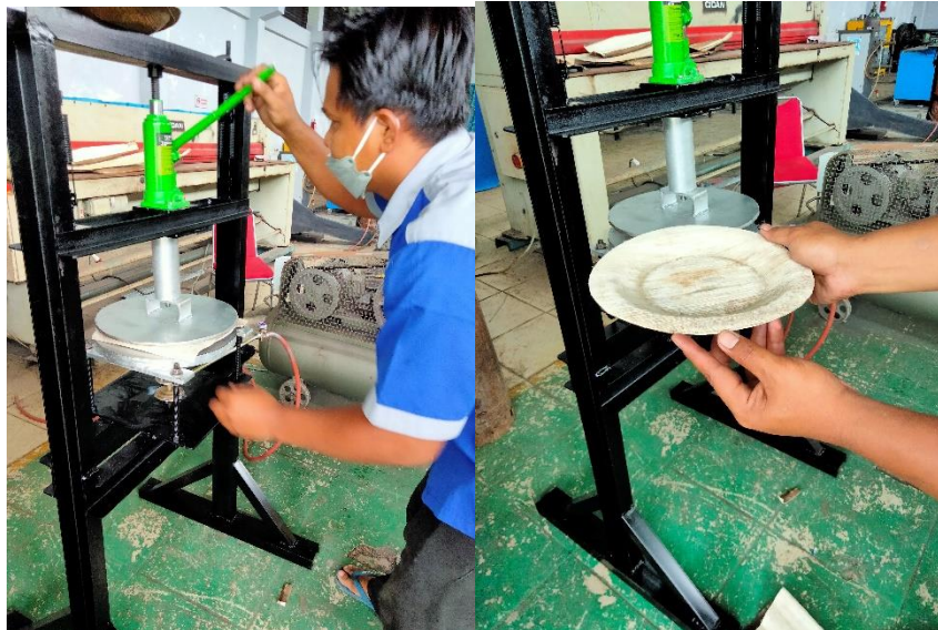
Gambar 3. Hasil pengujian alat press piring
